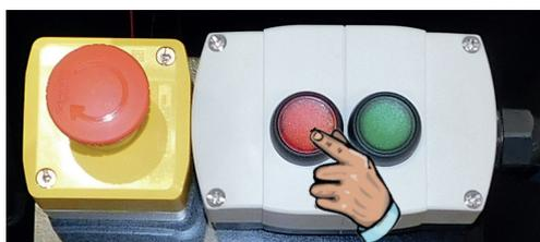
Pulse el botón verde de la consola de control del operario para iniciar el programa automáticamente.
